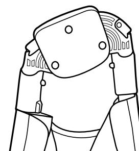
13. Alinee el extremo de la bisagra de la cuna con la ranura de posicionamiento con el brazo de la estructura de la cuna con la clavija e inserte el brazo en la bisagra. (Vea la figura A)
