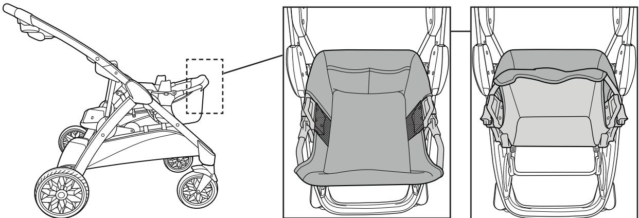
5 Para plegar el adaptador para asiento de seguridad infantil cuando no se utilice. Levante la estructura delantera y gírela hacia la estructura trasera.
