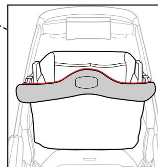
**1 El asiento modular puede retirarse para acoplar el adaptador para asiento de seguridad infantil.** Para retirar el asiento modular, presione los botones situados en el interior de ambos cubos, tal como se muestra, y levántelos para extraer el asiento.
